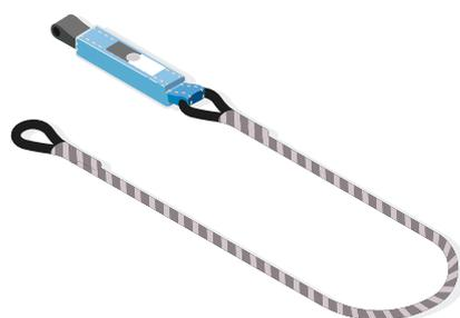
■ **Longe réglable avec absorbeur**, dont la longueur doit alors être soigneusement ajustée en fonction de la position du point d'ancrage, de la taille de la plateforme et de la morphologie de l'opérateur, afin que ce dernier ne puisse être éjecté au-dessus du garde-corps.
