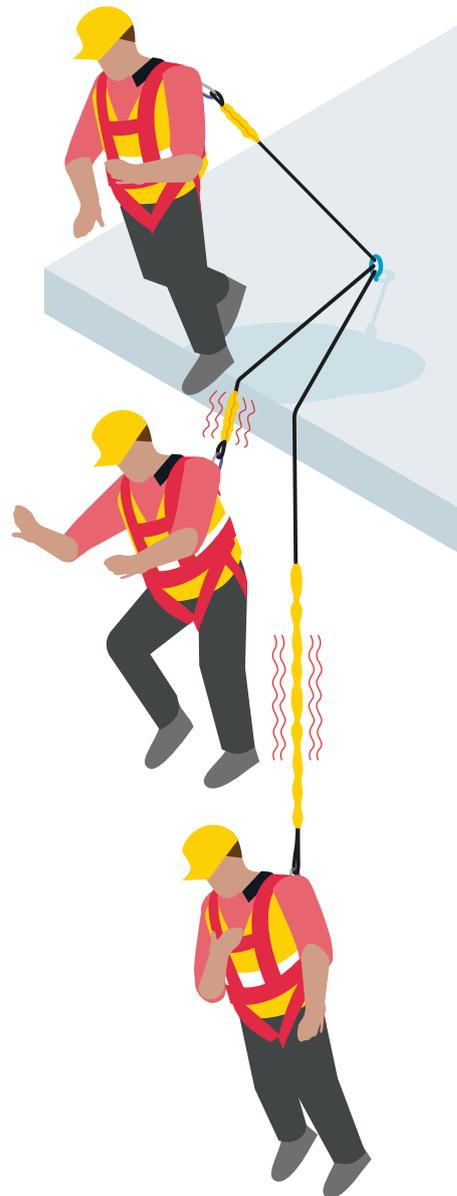
**i** L'absorbeur d'énergie est un composant essentiel d'un système d'arrêt des chutes. Il est conçu pour dissiper l'énergie cinétique causée par la chute en augmentant la distance d'arrêt, ce qui permet de réduire la décélération et donc l'impact subi par le corps.
